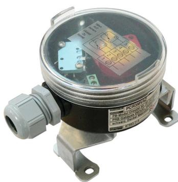
**Das kleine und sehr kompakte PRB-Modul kann mit Doppelsensoren unterschiedlicher Ausführungen ausgestattet werden. Die PRB-Baureihe ist mit einer luftdurchlässigen, atmenden Membran ausgestattet, wodurch sich das innere Luftvolumen mit der äußeren Umgebung austauschen kann und somit ein Kondensniederschlag vermieden wird.**
