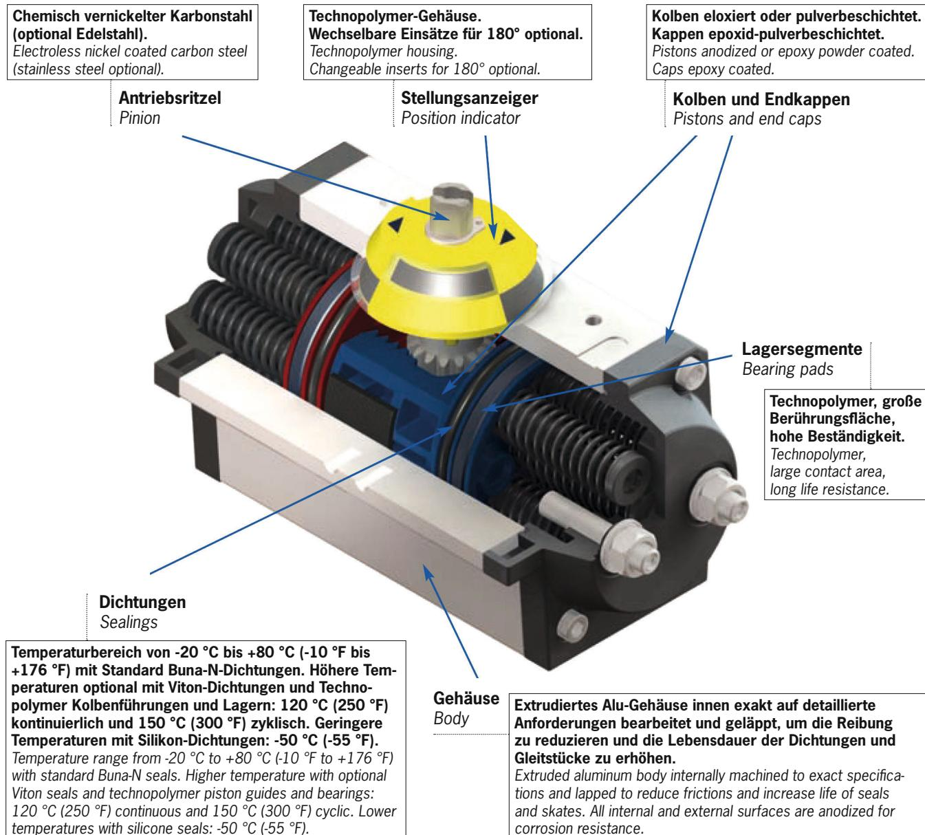
Das ausblassichere System des Ritzels ist doppelt gesichert durch eine C-Klammer und zwei eingefräste Keilnuten. Dies verhindert eine ungewöhnliche Abwärtsbewegung des Ritzels.
